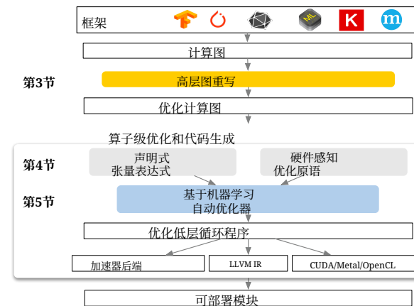
图2: TVM的系统概述。当前栈支持从许多深度学习框架和交换格式(如CoreML和ONNX)描述,以针对主要的CPU、GPU和专用加速器进行目标。
