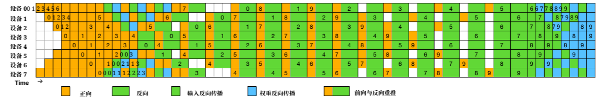
图 5 | 示例DualPipe调度，针对8个PP等级和两个方向中的20个微批次。反向方向的微批次与正向方向的微批次对称，因此为简洁起见，我们省略了它们的批次ID。两个由共享黑色边框包围的单元具有相互重叠的计算和通信。
